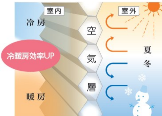
ハニカムスクリーン「ブレア」の構造。ハニカム(蜂の巣)構造の生地がつくる空気層が窓迎の断熱性を高め、冷暖房効率が向上。
