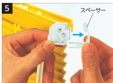
5 チルトギアから裏面のスペーサーを外します。
