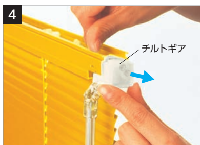
4 チルトギアをヘッドボックスから引き出します。その時ヘッドボックスの上部を指で広げぎみにすると引き出しが楽です。
